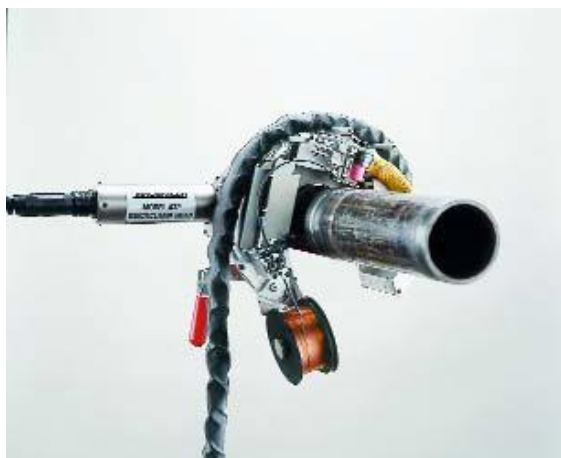
Поворотный держатель катушки. Уникальная конструкция поддерживает натяг проволоки, предотвращая изгиб (не требуется на модели 433)
